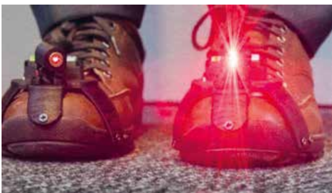
Zdroj laserového svetla na topánkach, ktorým sa vytvára svetelná čiara pred nohami, ktorú musí pacient prekročiť a následne sa rozchodí.
